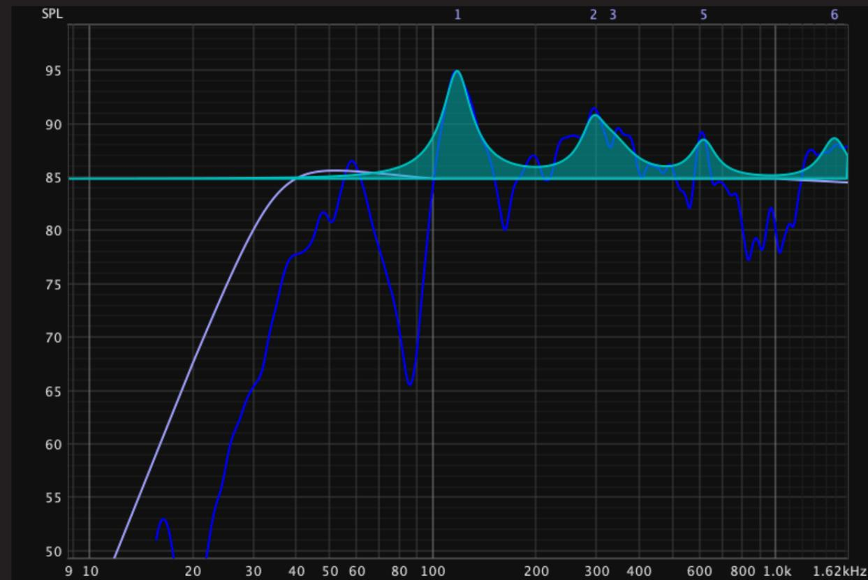
Abb.85: Full-Range-Analyse (Bassfallen + Breitbandabsorber) + Filter
