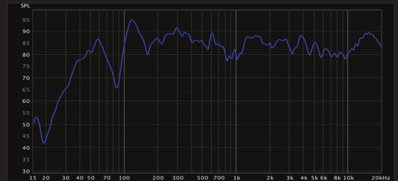
Abb.80: Full-Range-Messungen mit Bassfallen + Breitbandabsorbern
