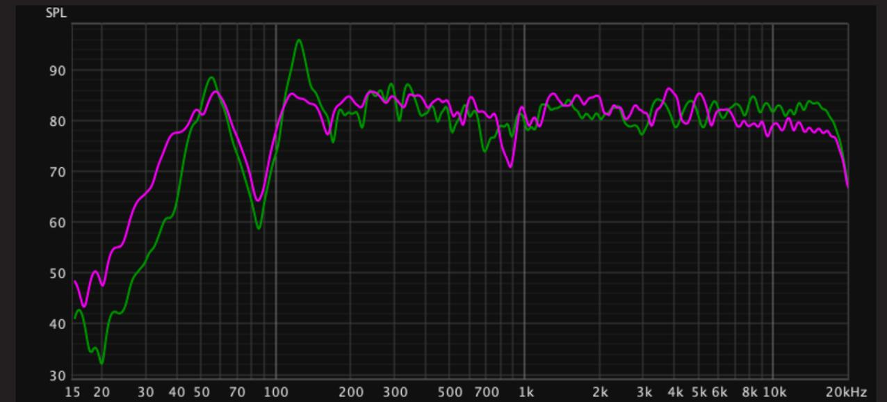
Abb.90: Vergleich der Full-Range-Messungen des leeren Raums und des behandelten Raums
