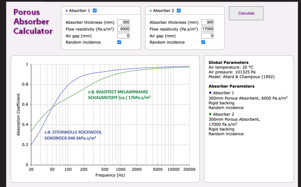
Abb.45: „Porous Absorber Calculator“ - 30cm
