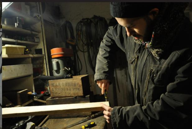
Abb.61: Eindrehen der Schrauben
