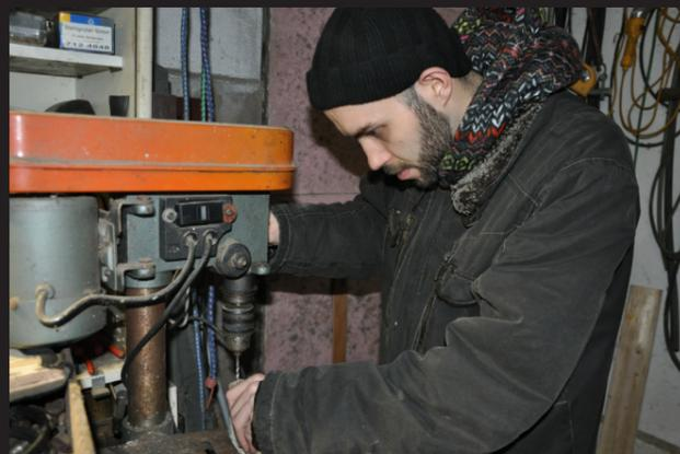
Abb.60: Bohren der Rahmenlöcher
