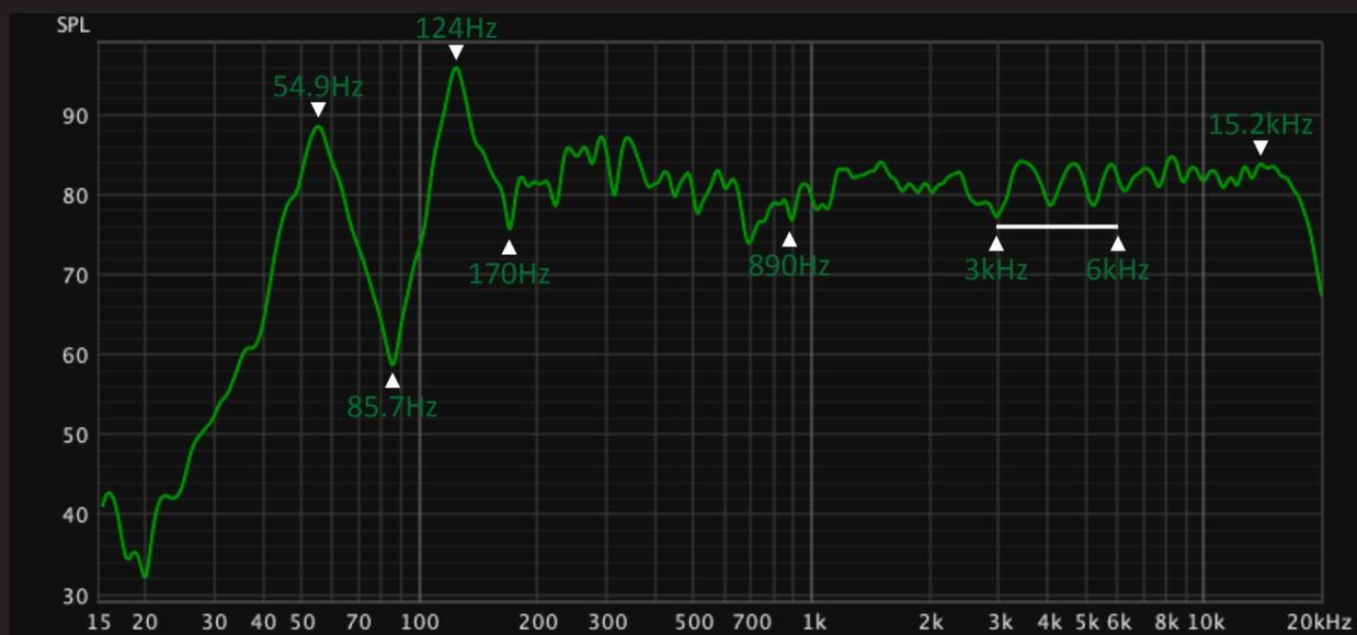
Abb.89: Full-Range-Analyse des leeren Raums (Default / Erste Messung)
