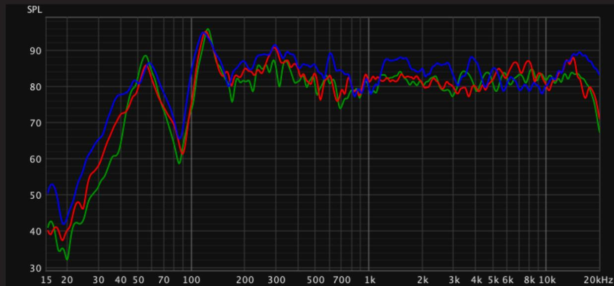
Abb.79: Vergleich aller Full-Range-Messungen (rote Linie = Raum nur mit Bassfallen)
