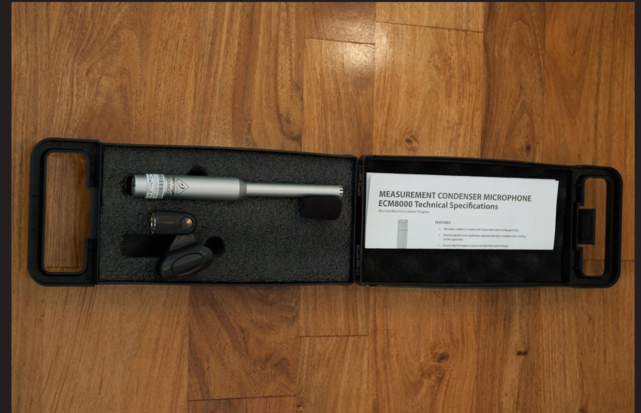
Abb.41: Das verwendete Messmikrofon - Behringer ECM8000
